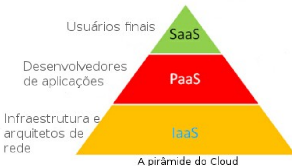
Figura 1: A pirâmide da computação em nuvem e quem interage com cada camada. Fonte: o autor.
